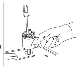
**Étape 3 - Raccordement au distributeur d'eau chaude** - Voir les instructions de montage du réservoir et le schéma ci-dessus pour le raccordement de la conduite rouge du robinet au tuyau d'arrivée se trouvant au coin arrière de la partie supérieure du réservoir.
